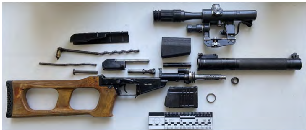
Зображення № 1. 9,0-мм гвинтівка спеціальна снайперська «Вінторез» у демонтованому стані.
