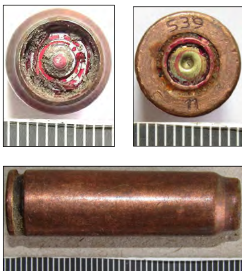
Зображення № 7. Донце та штовхач гільзи патрона СП-4 калібру 7,62x41 мм
