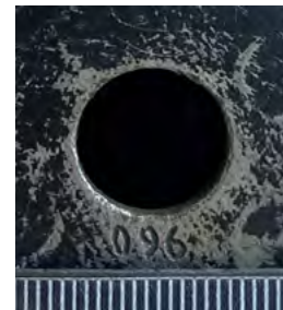
Зображення № 3. Маркувальні позначення на затворі, трубі зворотного механізму до затвора та дульному зрізі гвинтівки спеціальної «Вінторез»
