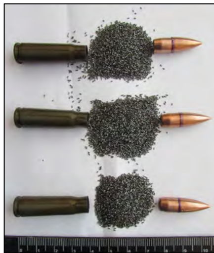
Зображення № 6. 7,62-мм патрон УС зр. 1943 р. зі зменшеною швидкістю (інд. 57-Н-231У), призначений для стрільби з приладом безшумної та безполум'яної стрільби ПББС-1
