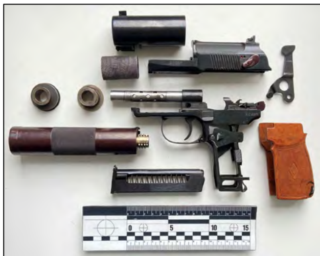
Зображення 11. 9,0-мм самозарядний пістолет безшумної стрільби (ПБ) у демонтованому стані
