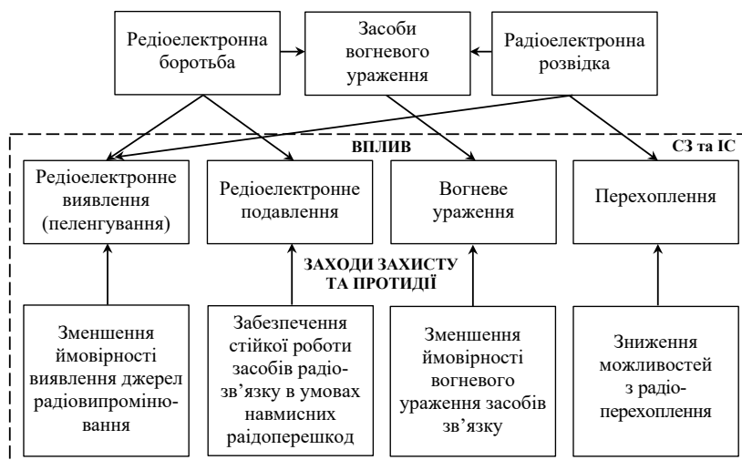
Рис. 1. Класифікація заходів радіоелектронного захисту системи зв'язку та протидії радіоелектронній розвідці противника
