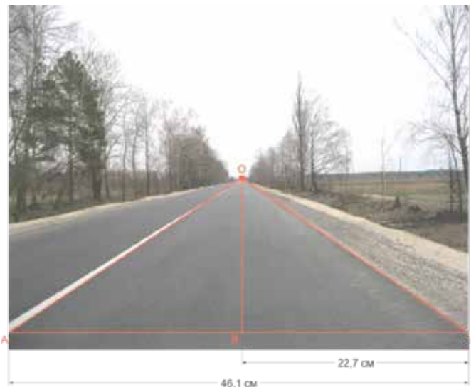
Рис. 6. Графічні побудови на кадрі фотозображення, де відстань від об'єктиву до правого краю проїзної частини становила 200 см
