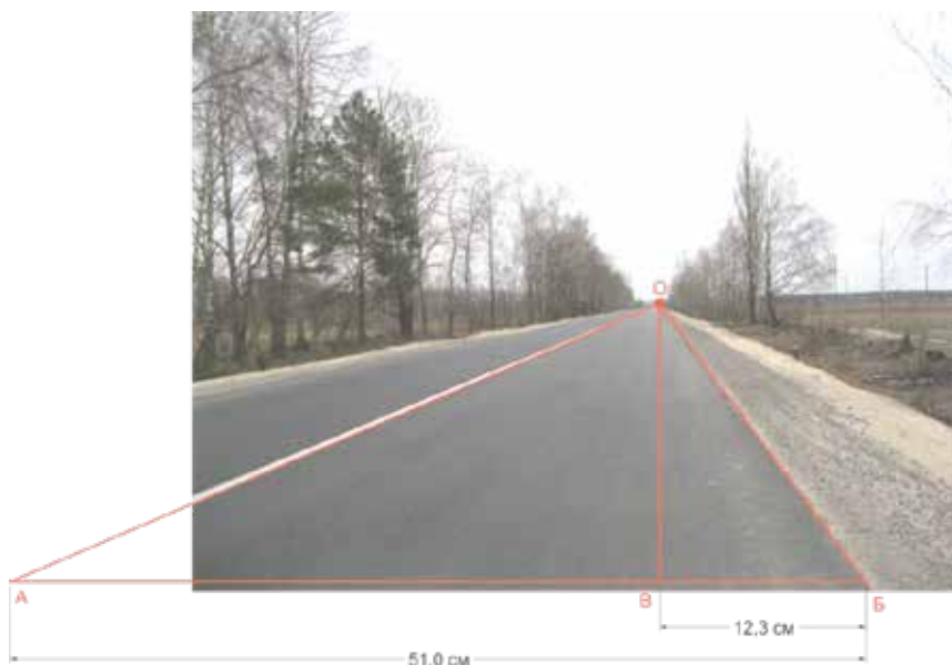
Рис. 5. Графічні побудови на кадрі фотозображення, де відстань від об'єктиву до правого краю проїзної частини становила 100 см
